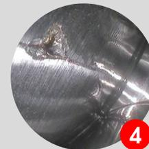
Bei Schäden an **Lagern für hohe/mittlere Geschwindigkeiten** handelt es sich häufig um feine Risse („weiße Ätzung“). Wir bieten dank ecoCMS **12 bis 36 Monate** Vorlaufzeit, sodass **kostenoptimierte Reparaturen am Turm möglich sind**.
