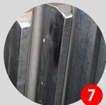
Risse in **Getrieben mit Planetenstufe**, die häufig durch metallische Einschlüsse entstehen, müssen in der Regel bis zur Reparatur **gedrosselt oder abgeschaltet** werden, um keine Risse im Getriebegehäuse zu riskieren.
