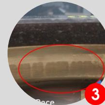
Rattermarken als Folge von Stromdurchgang sind eine Vorstufe des Abschälens, die zu katastrophalen Ausfällen von **Generatorlagern führen können**. Wir ermöglichen eine Vorlaufzeit von **6 bis 18 Monaten**.
