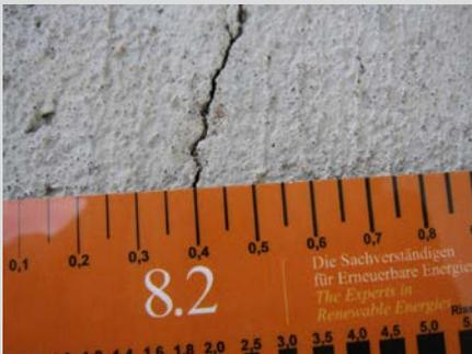
Abb. 8: Rissbreitenmessung am Beton.
