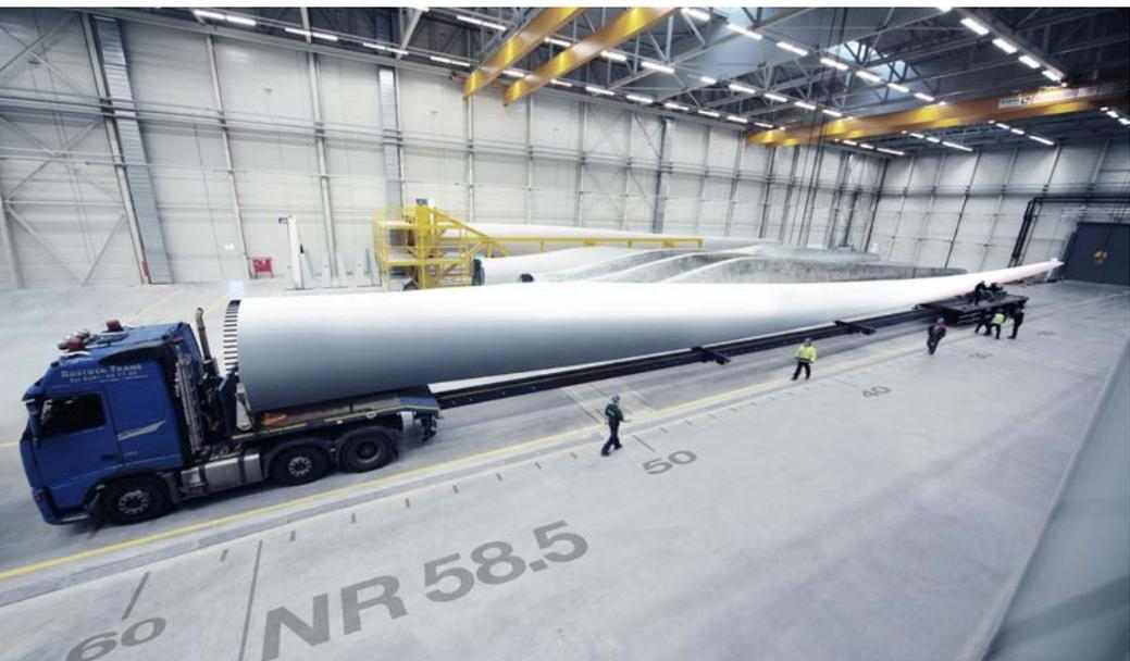
Lange Fracht: Rund 58 Meter misst dieses Rotorblatt. Foto: Nordex
