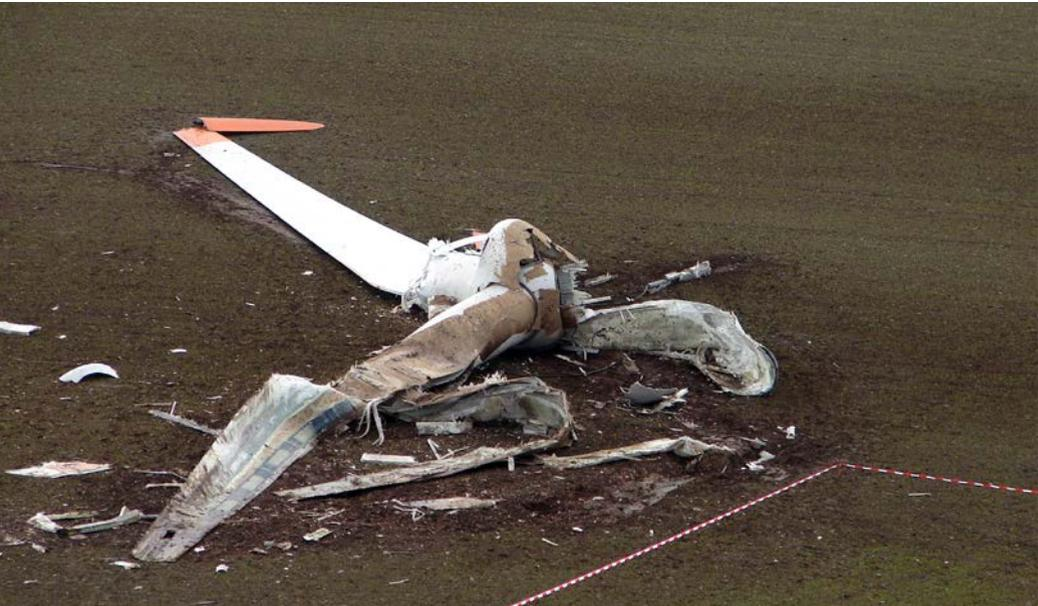
Abb. 11: Absturz eines kompletten Rotors
