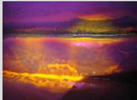
Abb. 9: Rissprüfung an der Schweißnaht mittels Farbeindringverfahren unter UV-Licht.
