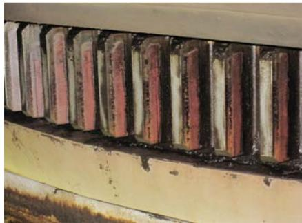
Abb. 16 und 17: Mangelschmierung an Verzahnungen (Blattverstellung und Windnachführung).
