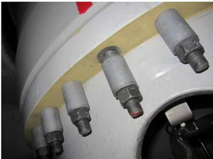
Abb. 14: Lose Rotorblattverschraubung.
