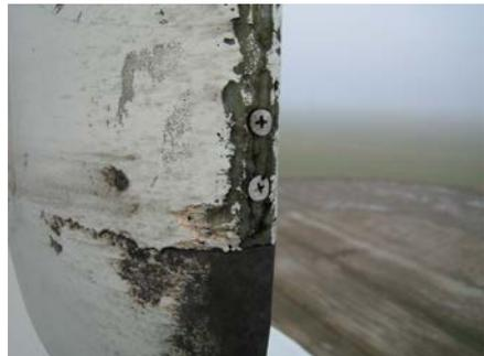
Abb. 15: Erosion an einer Blattvorderkante.
